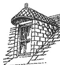
Lucarne en demi-cône en surplomb par rapport au nu de la menuiserie. (secteur nord)
