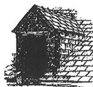
Lucarne à fronton, à deux versants faisant saillie sur le devant.
